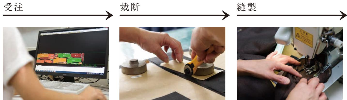
百貨店などからWeb入力システムやFAXで送られてくるオーダーシートをもとに、寸法、デザイン、仕様などをコンピュータのCADシステムに入力。生地を無駄にしないようパズルのように各パーツパターンを組み合わせ、CAM(自動裁断機)へデータを送ります。
